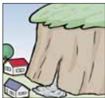
斜面から水がふきだす
